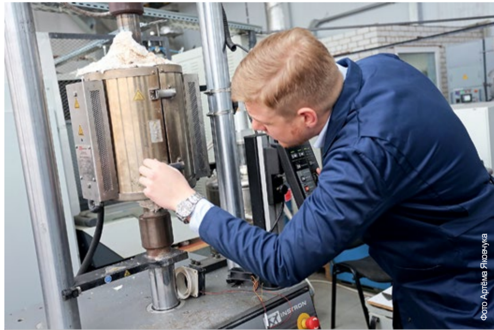
Младший научный сотрудник лаборатории объёмных наноструктурных материалов НИУ «БелГУ» Максим Озеров проводит деформационно-термическую обработку композита
